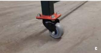
Les portes peuvent être installées n'importe où dans la ligne de clôture. Les portes pivotent sur la cheville ronde. Lors de l'installation d'une portee, placez un espaceur sur la cheville ronde (a). Avant de placer le panneau sur la base (b). Cela élèvera le panneau et permettra à la porte de pivoter librement. Installez la roue à l'extrémité opposée du panneau (c). Avec l'espaceur et la roue installée, la porte devrait être à niveau et pivoter librement.
